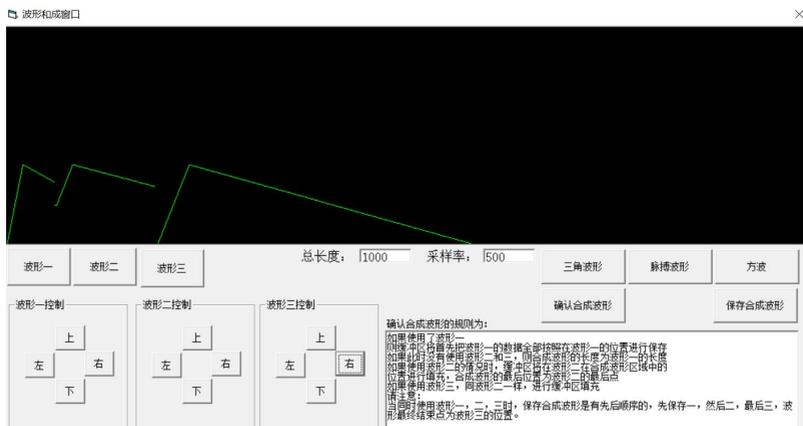
选择波形一，波形二，波形三，分别选择前期编辑好的三角波形或者脉搏波形，通过波形控制按键，分别对波形进行位移到需要的位置后，选择确认合成波形即可预览合成后的波形，选择保存合成波形后可以放置文件到 U 盘位置进行波形输出。
