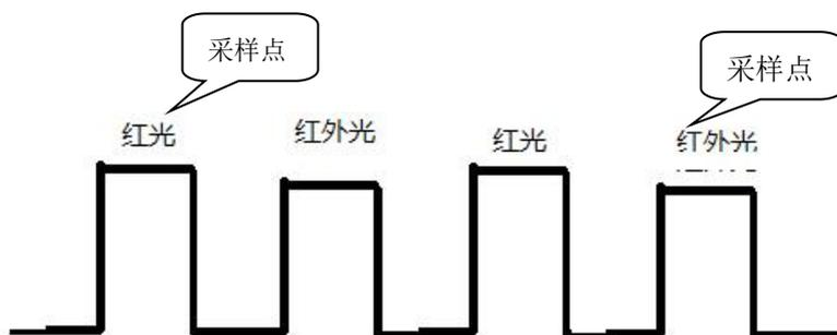
如上述波形类似，已经载有血氧波形数据了，在此情况下，应根据波形幅度的大小来对波形进行放大处理，最后进入到 CPU 的 AD 部分直接进行采集即可，注意的是，不需要把上述波形进行分离了，只需要在 CPU 程序端根据发光部分的时序，在对应的时间点上来采集波形就可以了，建议应该在关闭并切换发光管前来采集 AD 信号，这样最大程度的来得到有效数据，如果脉冲宽度够宽，可以在脉冲的中间点采样也可。
