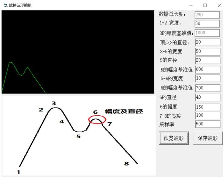
编辑波形时请注意波形的平滑度，更改各个参数同时使用预览波形，编辑生成想要的波形。
