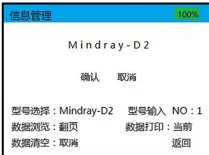
选择型号输入中的序列，确认后，出现上述显示内容，通过旋钮，可以对每个字母进行更改，输入需要的机器型号后，选择确认键进行型号确认即可；型号输入和型号选择一一对应的，一共可以输入 16 个机器型号；在型号输入过程中，可以选择取消输入，则更改的内容不再生效；
