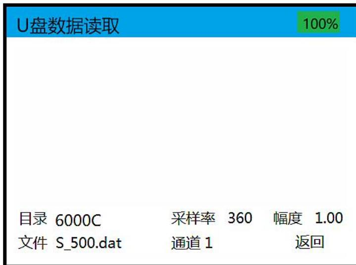
通过此窗口可以选择 U 盘中存放的多个数据库内容的波形文件，进行波形输出，可以输出 nstdb, mitbih, ahadb, cudb, sventdb, fibdb, ventdb 的波形，并且选配 280 多种异常波形组成的真实 ECG 波形数据库；
