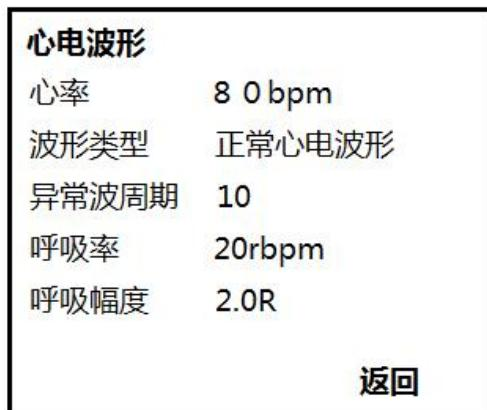
**心率**：设置正常心电波形的心率值，同步输出 12 导心电波形；
