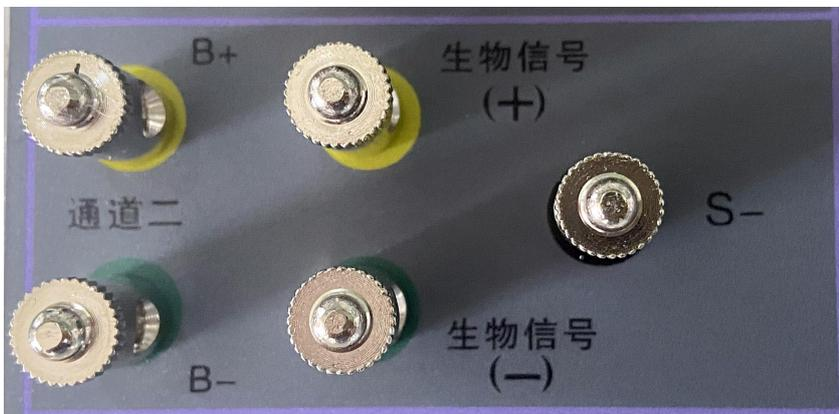
在软件通道二的窗口设置中，设置波形的类型，频率及幅度后，模拟仪将通过通道二的输出
